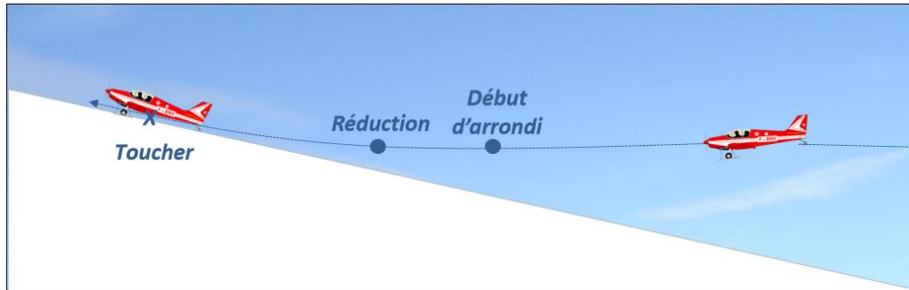
Fig. 132 – Un point d'aboutissement au seuil de piste laisse une marge de sécurité maximale
