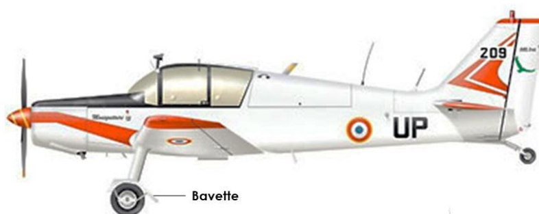
Fig. 138 – Exemple de bavettes de roues du D140 'Mousquetaire Abeille' (@Olivier Beermaert)
