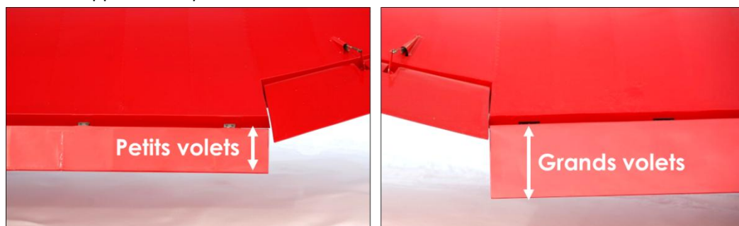
Photos 26 et 27 - La différence de largeur entre les deux types de volets est patente
