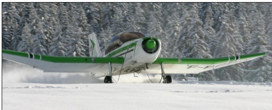
Photo 30 - Soufflage de l'aile au décollage
