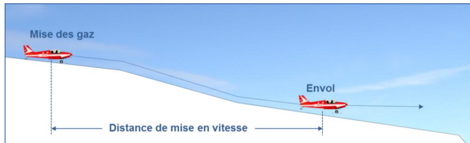
Fig. 66 - Profil de mise en vitesse sur la piste de Méribel (en coupe)
