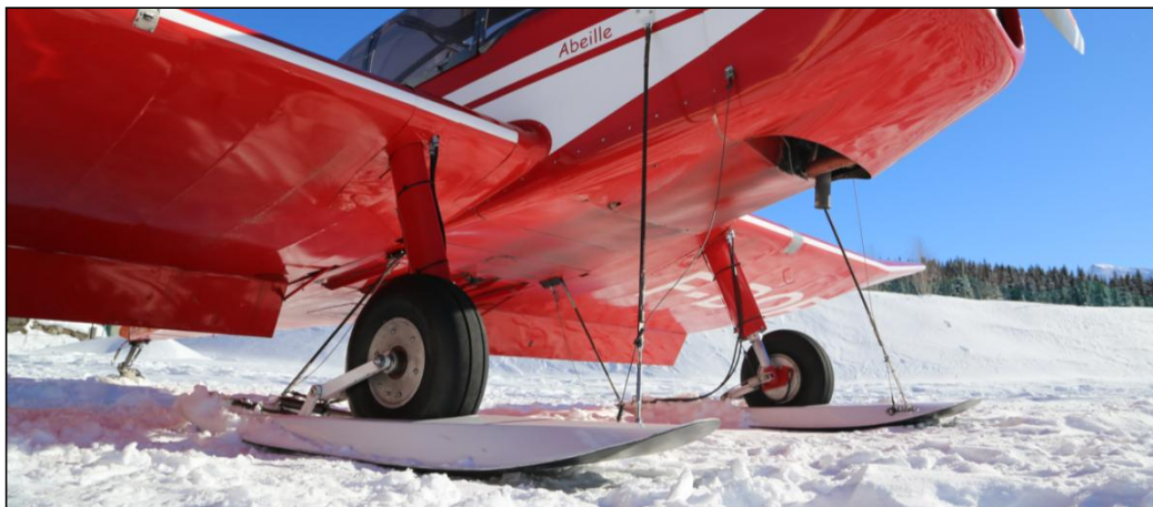
Photo 25 - Détail du montage des skis avant la visite PRÉVOL
