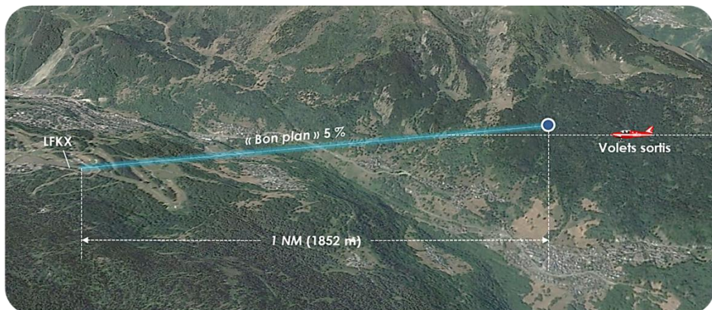
Fig. 99 – Une approche du bon plan « par le dessous » d'intercepter le bon plan
