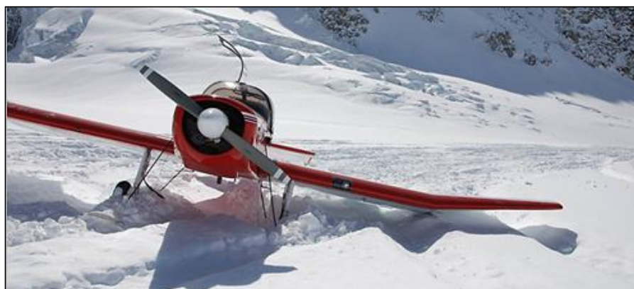
Photo 43 – Lors du virage en direction de la pente, le ski aval risque de s'enfoncer dans la neige
