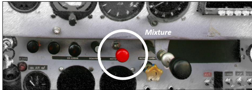
Photo 16 - Sur altiport, tirer la mixture d'environ deux centimètres
