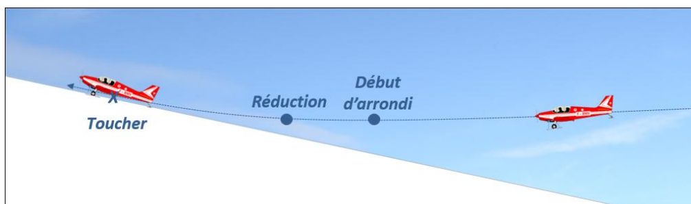
Fig. 131 – Décélérer lorsque l'avion est sensiblement parallèle à la piste
