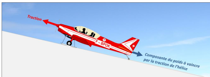
Fig. 15.15 – Sur pente enneigée, obtenir l'arrêt de l'appareil en maintenant une traction hélice
