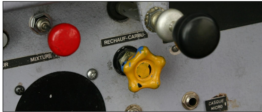
Fig. 57 - Gros plan du réchauffage carburateur sur froid
