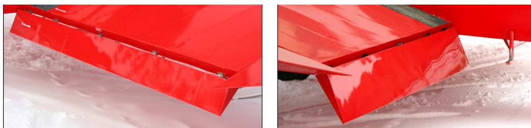
Photos 28 et 29 - Vue de profil des volets de courbure sortis
