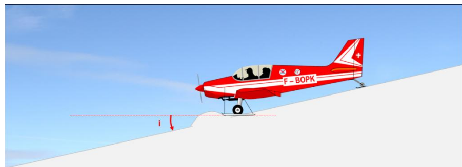
Fig. 15.19 – Une forte incidence ski/neige ( i ) bloque l'avion...
