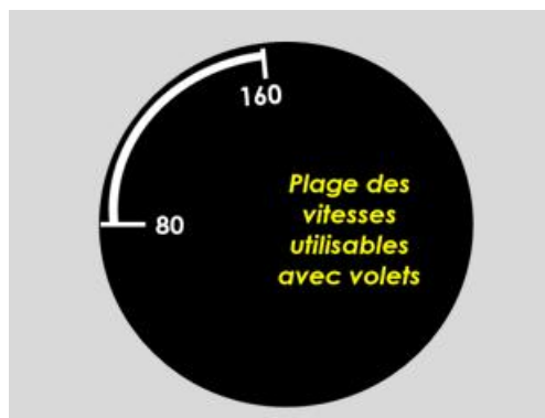
Fig. 97 – L'arc blanc de sortie des volets
