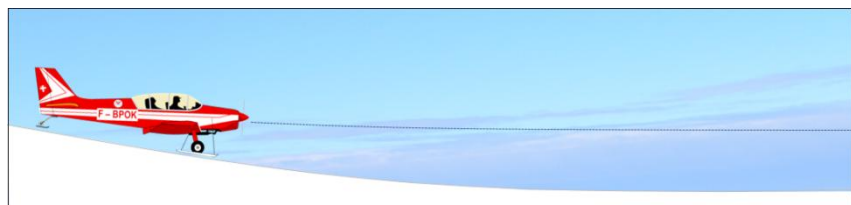
Fig. 8 - Un profil concave rend le décollage plus difficile
