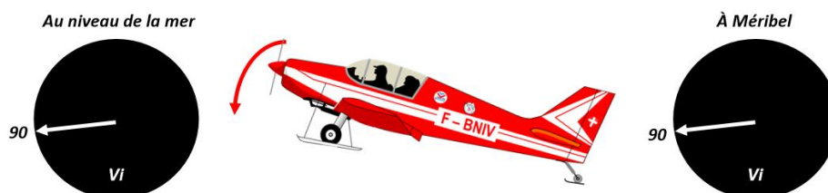
Fig. 5 - L'altitude n'a aucune influence sur la Vitesse indiquée (Vi) de décollage
