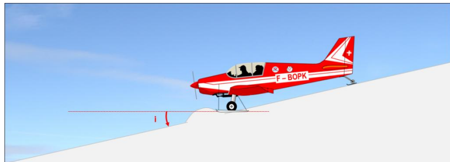
Fig. 15.19 – Une forte incidence ski/neige ( i ) bloque l'avion...
