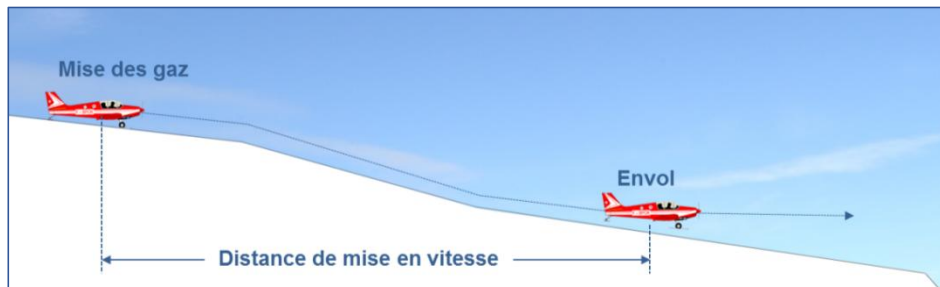
Fig. 70 - Profil de mise en vitesse sur la piste de Méribel (en coupe)
