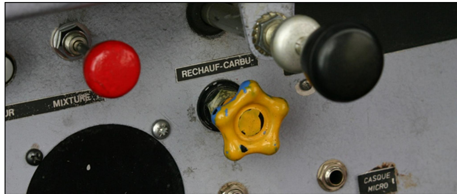
Fig. 59 - Gros plan du réchauffage carburateur sur froid
