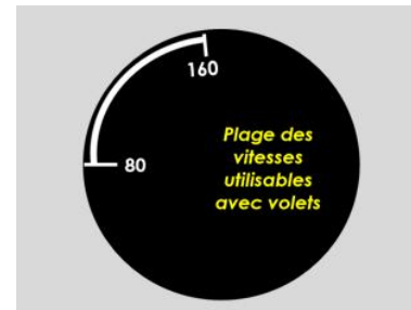
Fig. 100 – L'arc blanc de sortie des volets
