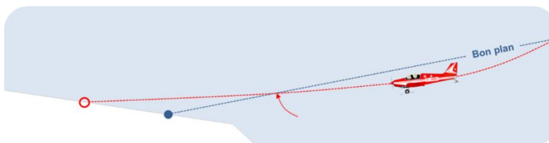
Fig. 126 – Le pilote rejoint le bon plan par le dessous...
