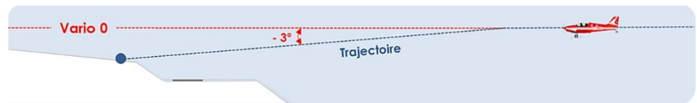
Fig. 118 – Sur le bon plan, la trajectoire amène l'avion sur le point d'aboutissement
