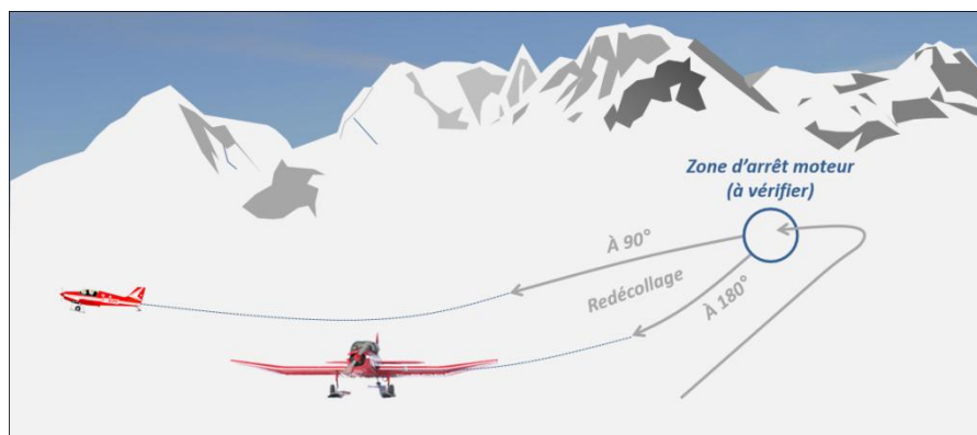
Fig. 15.17 –Selon la configuration du terrain, le pilote peut redécoller à 90 ou 180°...
