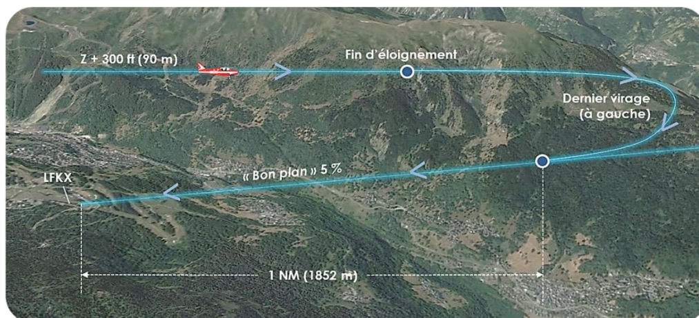
Fig. 101 – L'appareil se présentant à l'est, il effectue un virage à gauche descendant pour prendre le bon plan
